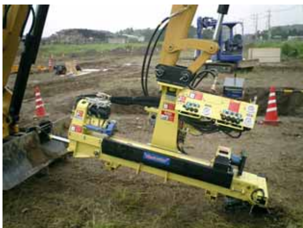
掘削機械のアームにアタッチメント式で取り付ける推進機
