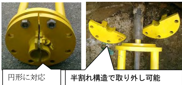
写真-10 拡径前の断面に対応する構造
