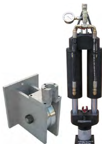
写真-1 ワイヤー引き込み機
